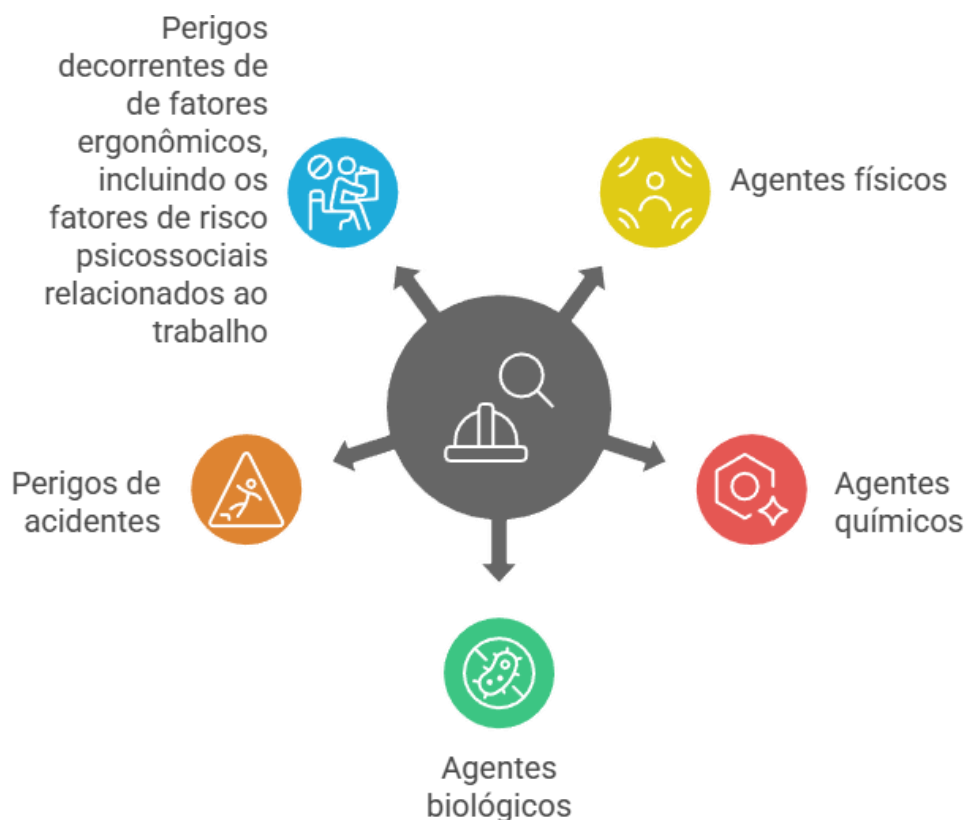
Figura 20 – Perigos ocupacionais incluídos no GRO/PGR
