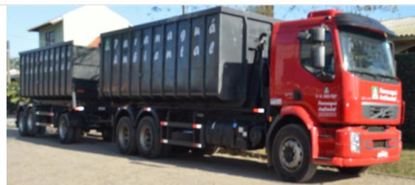
Figura 3 - Tipo de caminhão roll-on e roll-off
