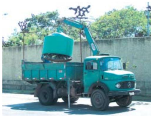
**Figura 9 – Caminhão Munck para coleta dos resíduos de vidro em Belo Horizonte. Fonte: SLU/PBH.**
